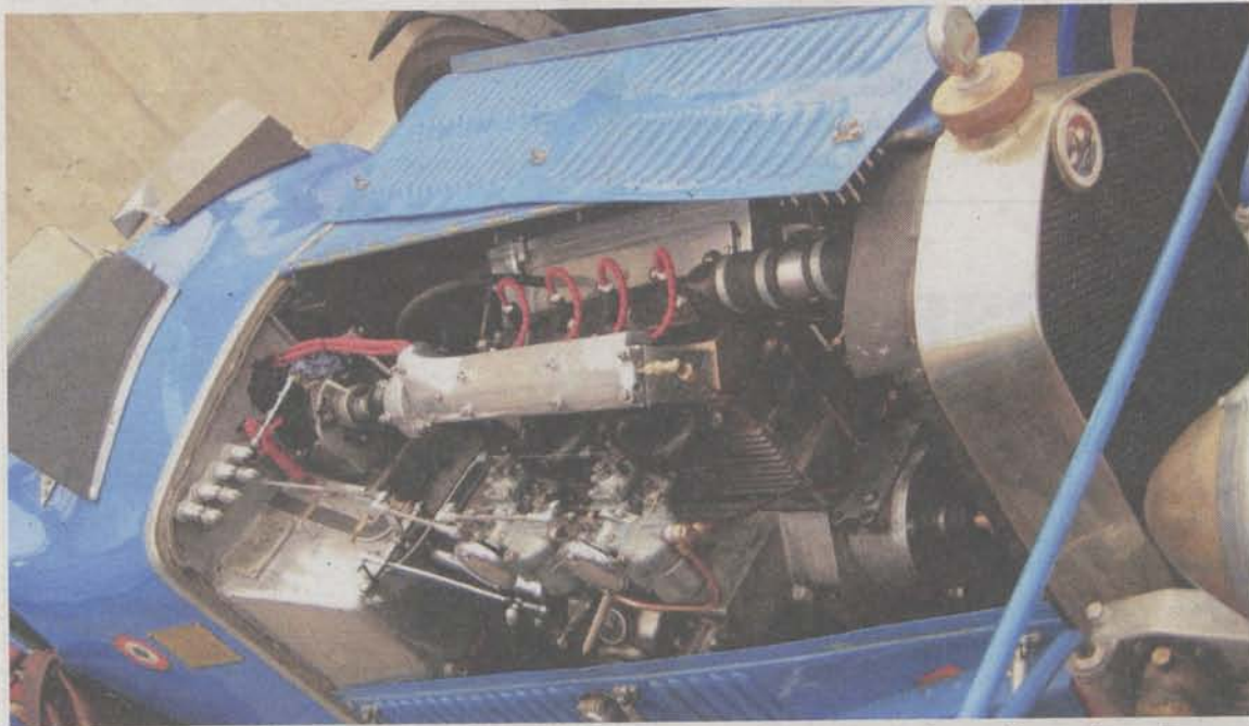
Het 1500cc motorblok in de Lombard AL3 Grand Prix uit 1927 telt twee bovenliggende nokkenassen en een van brons gegoten cilinderkop.
